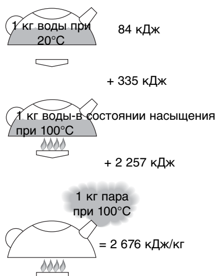
Рисунок CG-12-1. На этих рисунках показано сколько тепла потребуется, чтобы произвести 1 кг пара при атмосферном давлении. Заметьте, что для повышения температуры воды до точки кипения требуется 4,186 кДж на каждый градус 1°C, но для превращения воды при 100°C в пар при температуре 100°C требуется значительно больше тепла.
